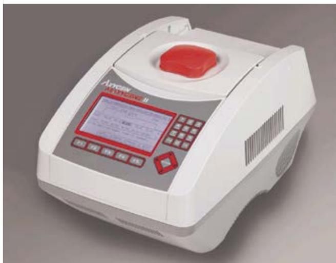
Le MaxyGene II est un thermocycleur comportant un bloc 96 puits composé de 6 éléments Peltier indépendants. Jusqu'à 6 températures d'annealing différentes peuvent être programmées pour optimiser les conditions de la PCR.
