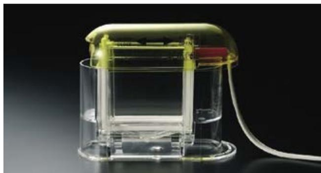
La cuve d'électrophorèse Fastgene® est livrée complète avec cuves, électrodes anode et cathode, couvercle avec les câbles, joints, deux plaques en acrylique.
