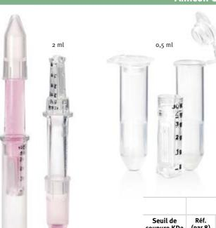
Dispositif d'ultrafiltration par centrifugation pour solutions protéiques diluées. Tube à insert avec membrane d'ultrafiltration.
