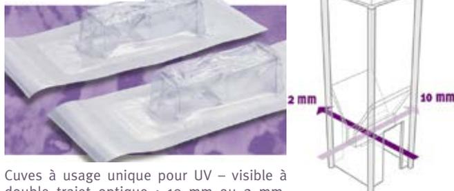
Cuves à usage unique pour UV – visible à double trajet optique : 10 mm ou 2 mm.
