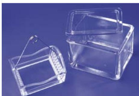
Boîtes en verre sodocalciques. Constituée d'une cuve, d'un panier et d'un étrier (chaque élément est à commander séparément).
