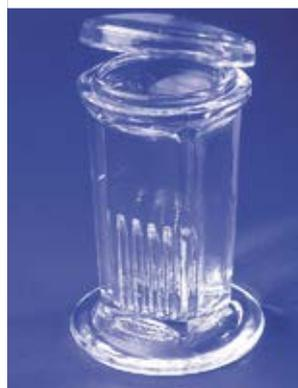
Boîtes en verre sodocalcique avec couvercle, de type Coplin. Capacité : 5 lames 76 x 26 mm ou 10 lames dos à dos.
