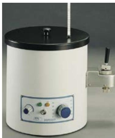
Pour températures réglables de l'ambiante + 5 °C jusqu'à 100 °C. Stabilité ± 1,5 °C. Panneau de commande :
