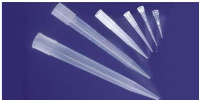
Pointes spécialement conçues pour les PIPETMAN® Gilson et pipettes Rainin.
