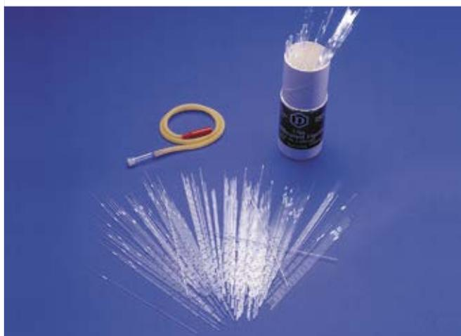
De très grande précision, ces capillaires en verre, polis à la flamme, sont calibrés rigoureusement avec une précision de  $\pm 0,5\%$ . En boîte de 250, avec un tuyau d'aspiration.
