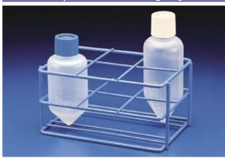
Portoir autoclavable en acier recouvert d'epoxy pour le support de bouteilles à fond conique à centrifuger, de type Corning, Falcon, Nunc.
