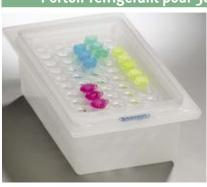
Portoir avec réservoir réfrigérant pour glace ou eau, pour 50 microtubes ou tubes de diamètre inférieur ou égal à 12 mm.
