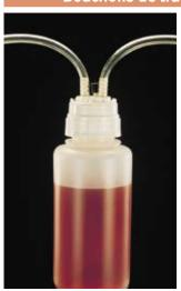
Bouchons avec tubulure pour le remplissage et la vidange de bonbonnes Nalgene™ en conditions aseptiques.
