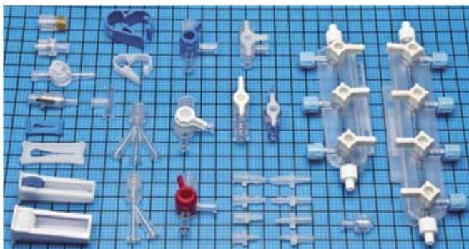
Kit contenant une large gamme de valves et connecteurs pour les systèmes d'écoulement de liquide.
