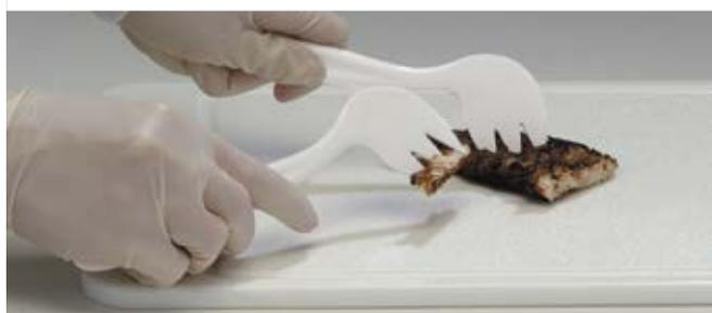
Cuillère en polycarbonate moulée, indentée et avec trois griffes formant une fourchette. Pour couper facilement les échantillons à prélever stérilement. Autoclavables à 121 °C.
