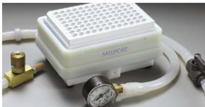
Système de filtration sous vide pour plaques 96 puits Multi-screen HTS. Comprend : la base, le cadre pour plaques 96 puits (format standard avec joints), la grille support, les tuyaux, une vanne ON/OFF, une vanne de régulation du vide, un manomètre.
