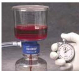
Se fixent sur un flacon en verre de type ISO, Pyrex ou Schott, à col 33 ou 45 mm.
