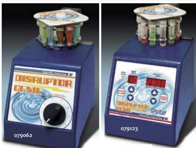
L'agitateur Genie Disruptor convient tout particulièrement à l'éclatement et l'homogénéisation de cellules difficiles, bactéries, tissus animaux ou végétaux, remise en suspension de pellet, ainsi qu'à toute application demandant une agitation extrême. Complet avec support TurboMix pour 12 microtubes 1,5 ml ou 2 ml à capuchon vissant.
