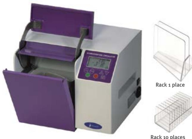
Broyeur à double action de malaxage et d'agitation pour l'homogénéisation des échantillons directement dans des sachets stériles. Le fond rond des sachets, combinée à la forme de ses pales circulaires assurent une récupération optimale des cellules et organismes contenus dans les échantillons à traiter.
