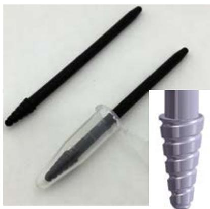
► Idéal pour l'homogénéisation de tissus mous (foie, cerveau et muscle...) et des précipités, et la remise en suspension du culot de centrifugation
