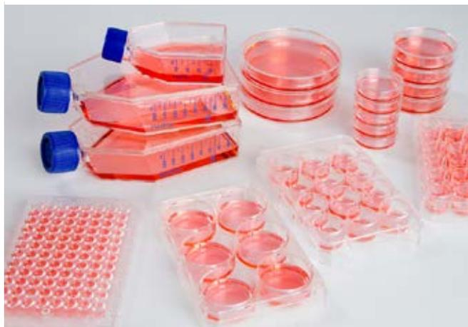
Les supports Nunc™ Nuclon™ Sphera™ permettent l'optimisation de la culture en forme de sphères. Ils sont adaptés pour différents types de cellules.
