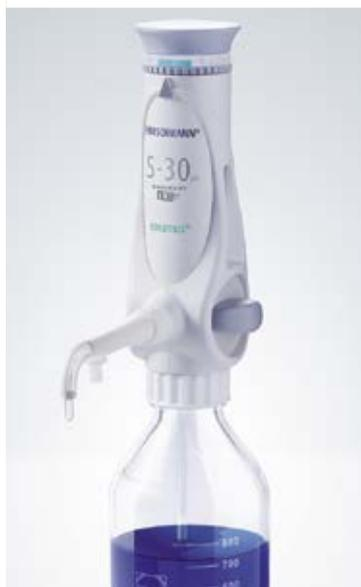
Distributeurs de liquide à piston en céramique et tête entièrement mobile sur 360°, pour distribution de solutions de 0,2 ml à 60 ml.
