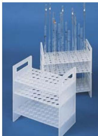
Portoir pour le rangement vertical de 50 pipettes (5 x 10). Le plateau du bas évite le contact de la pipette sur la paillasse.
