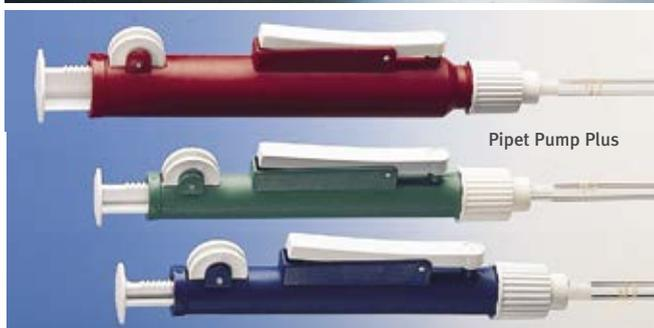
Pipeteur économique manuel pour toutes pipettes de 0,2 ml à 25 ml. Par simple actionnement de la molette latérale, le Pipet Pump aspire le volume et le distribue. Le Pipet Pump Plus dispose d'une manette de distribution plus rapide et d'éjection de la dernière goutte de la pipette.
