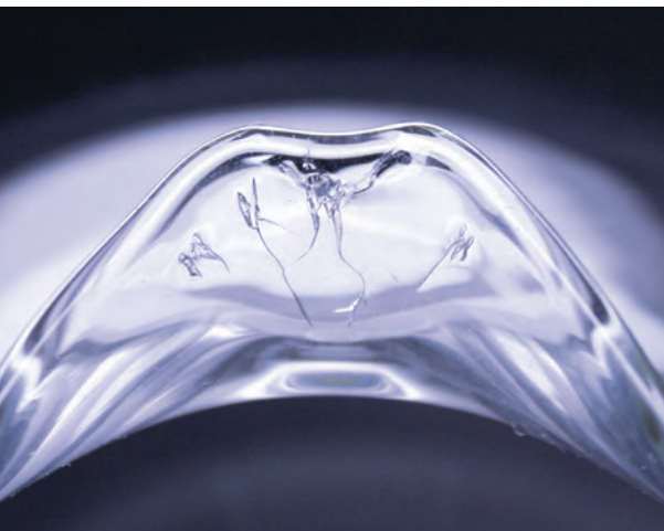
Fissures dans le verseur d'un bécher de laboratoire
