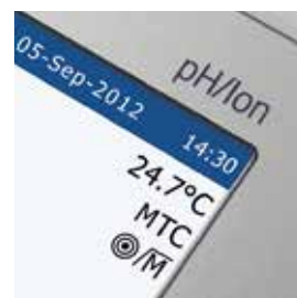
Figure 8 : Indication de la température et de la MTC sur un pH-mètre.
